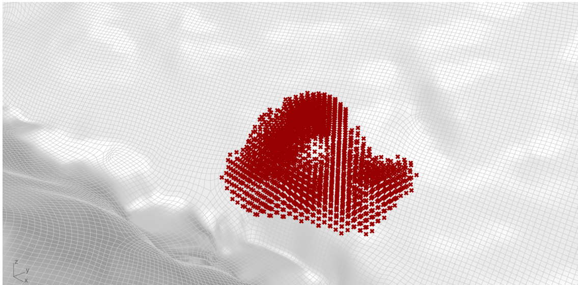
Ilustración 21: Captura de la nube de 2.189 puntos, acotación del dominio de cálculo a los valores superiores a 1 N/mm 2 , tramo 6.
