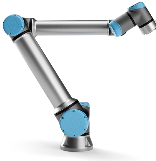
Ilustración 4: Brazo robótico UR10, de la firma Universal Robots, escogido para la fabricación aditiva de la estructura por su óptima relación alcance / peso: 1300 mm / 33,5 kg.
