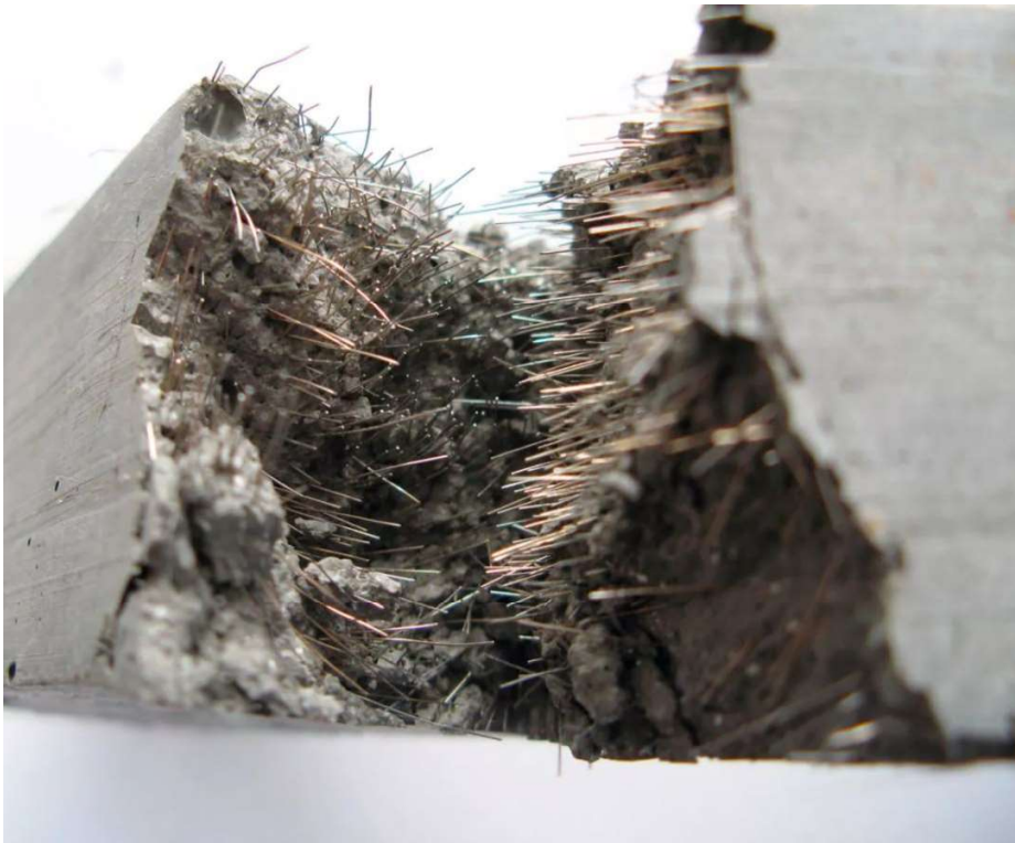
Fig. 1.3. Elemento de UHPFRC fracturado, en el que se observan las fibras de acero incorporadas en la matriz del material.
