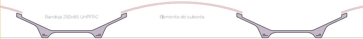
Sección general de cubierta con bandeja 250x56 UHPFRC Esc. 1:50
