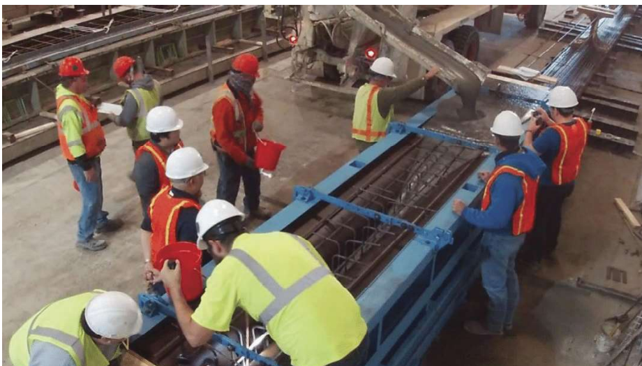
Fig. 2.22. Vertido de UHPFRC en encofrado metálico curvo para producción de viga tipo X.
