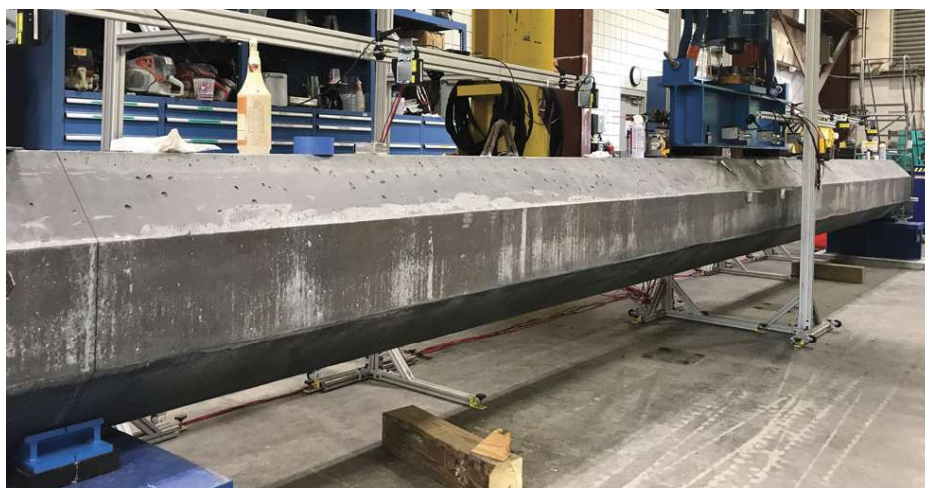
Fig. 2.6. Test a flexión del pilote octogonal hueco de UHPFRC en el Centro de Investigación de Estructuras del FDOT.
