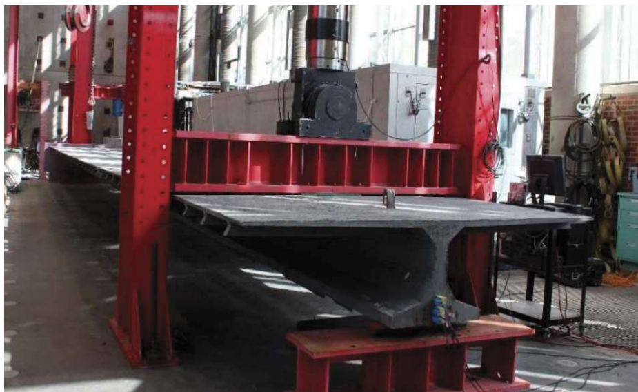
Fig. 2.28. Proceso de testado a cortante de la viga-tablero en I del PCI.
