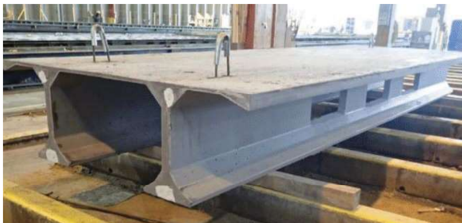
Fig. 2.27. Modelo testado de placa nervada, con la mitad de ancho, 1,83 m, y solo dos costillas o refuerzos.
